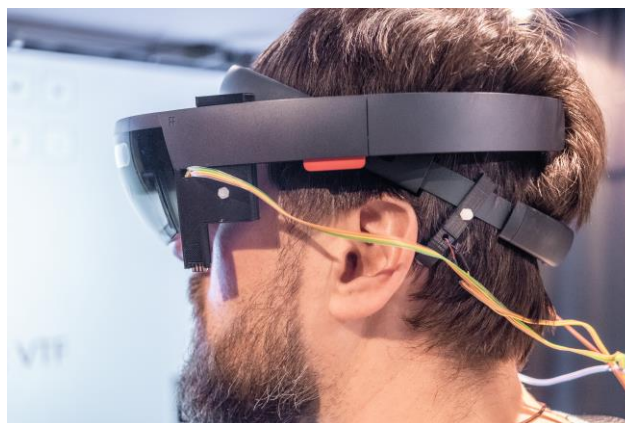
Abbildung 1: Versuchsteilnehmer mit HoloLens mit peripher visuellen und taktilen Interaktionselementen
