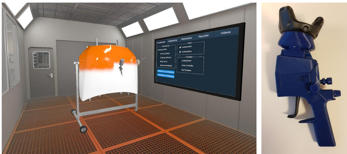
Abbildung 1: (links) Ausschnitt der virtuellen Lackierpistole mit halb lackiertem Werkstück. (rechts) gedruckte Lackierpistole mit Vive Tracker 4 zur 3D-Ortung im Raum
