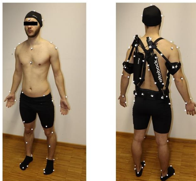
Abbildung 1: Proband mit retro-reflektiven Markern (links) und dem Exoskelett (rechts)
