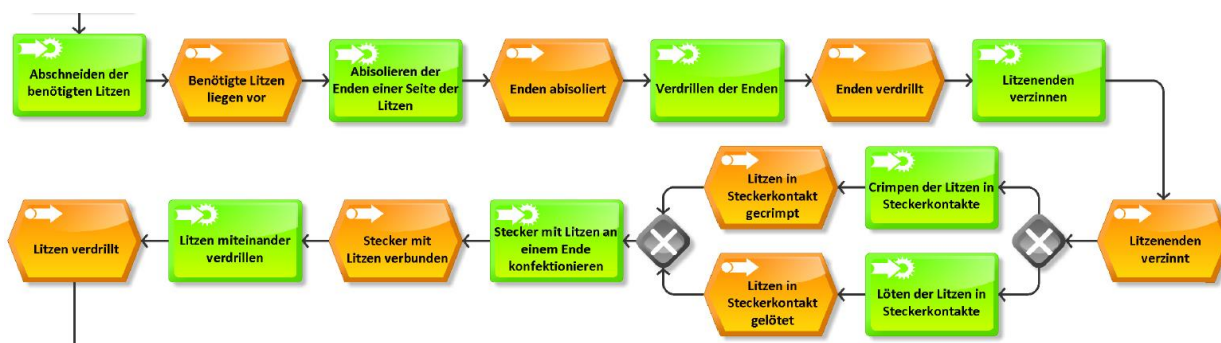
Abbildung 1: Ausschnitt aus dem Verdrahtungsprozess der Steuerungsplatine
