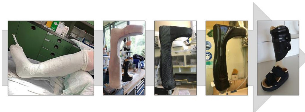
Abbildung 1: Konventionelle Herstellung einer Unterschenkelorthese aus CFK (Schafran & Kullmer 2019)
